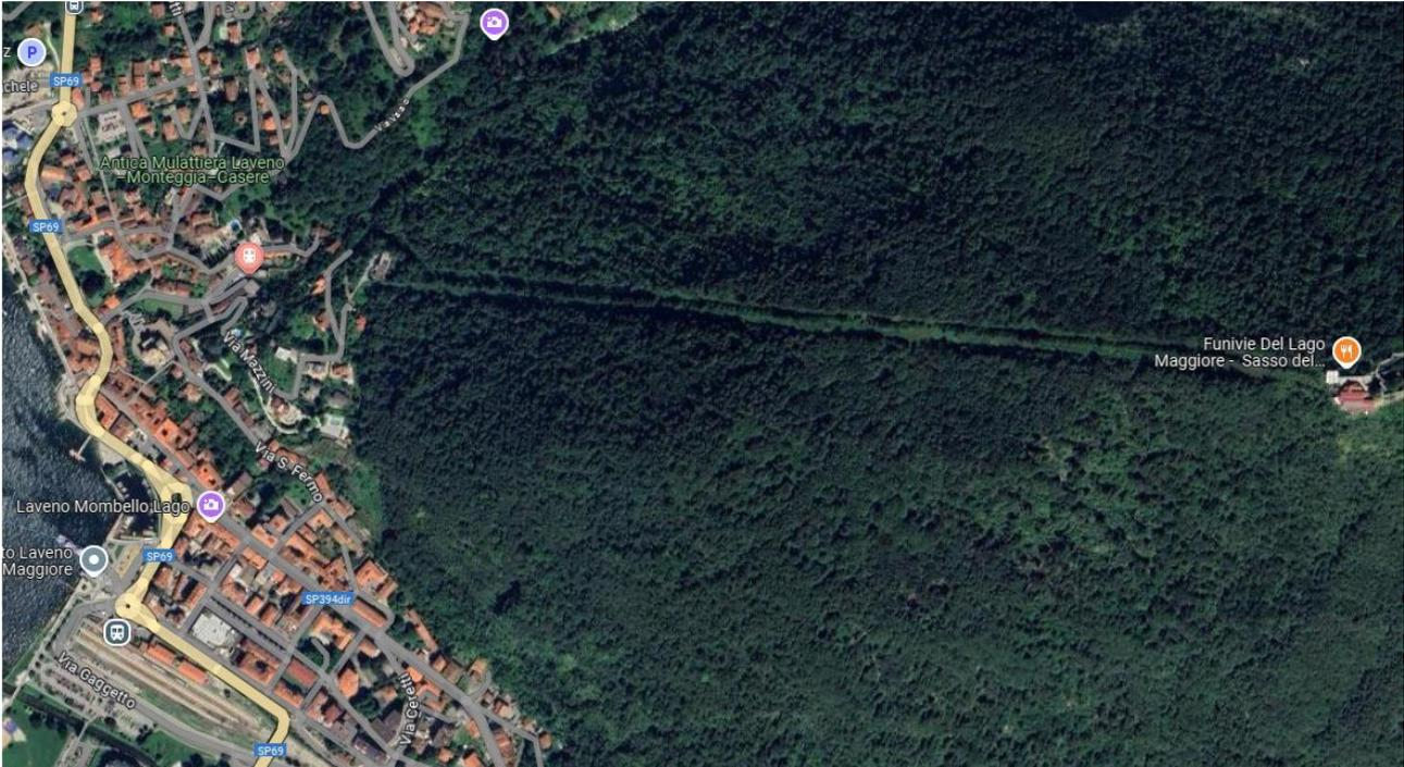
L'impianto è costituito da una stazione di valle, sita in via Tinelli e una stazione di monte sita in Poggio S. Elsa. Le due stazioni sono collegate da una cabinovia biposto ad attacchi fissi.
